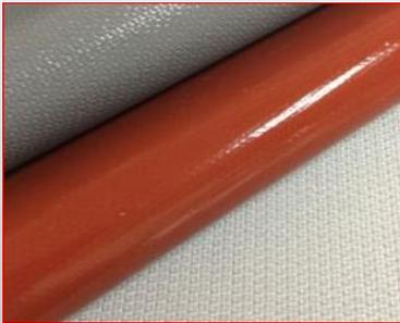
Material de película laminada para aplicaciones industriales y alimenticias con refuerzo sobre la tela de PTFE de espesor uniforme, su permeabilidad es menor que los productos recubiertos, una resistencia a grasas, permite cambios en las propiedades tales como la transferencia de calor permitiendo el trabajo continuo a una temperatura máxima de 260° C y resistencia al desgaste
